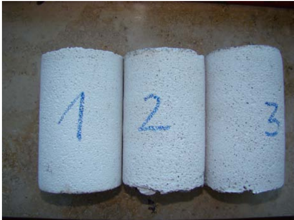
Bohrkerne aus einer Dachplatte
