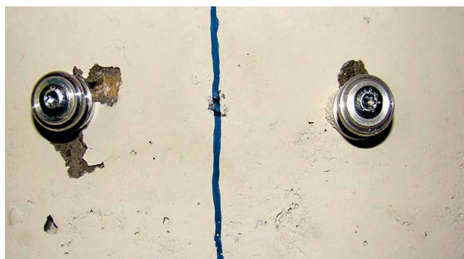
Abb. 1: Zweipunktmessung. Nur die Rissbreite kann sich ändern.
